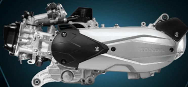
Với thiết kế nhỏ gọn, eSP-động cơ 125cc, 4 kỳ, xy-lanh đơn, làm mát bằng dung dịch & tích hợp những công nghệ tiên tiến nhất. Nhờ đó, Air Blade 2015 vốn đã đạt hiệu suất tiêu hao nhiên liệu ấn tượng nay tiếp tục được cải thiện để tiết kiệm nhiên liệu hơn 4% so với phiên bản Air Blade 2014.
